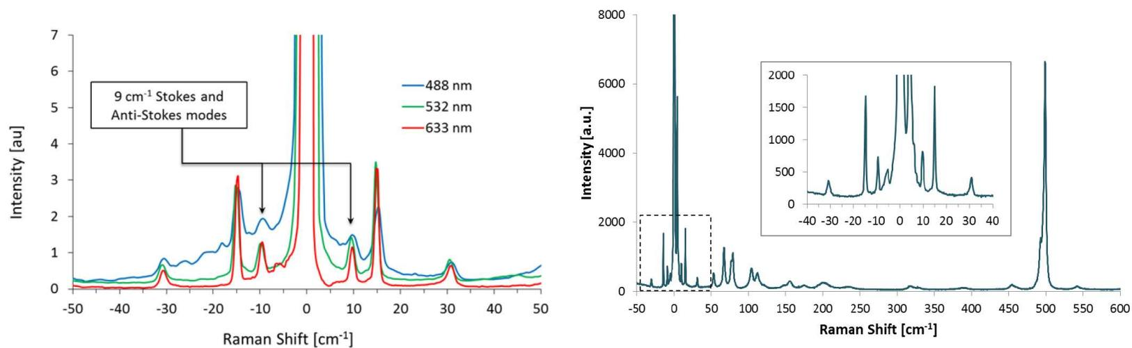
異なる4波長による超低波数ラマン測定結果: 488, 532, 633nm(左図)と785nm(右図)
