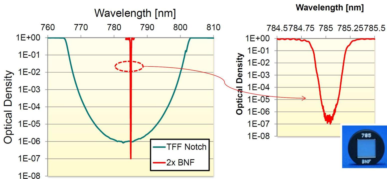
市場で入手可能な最もバンド幅が狭い薄膜フィルタとBNFのスペクトルを比較したグラフです。BNFのバンド幅の代表値が、約100-200pmであるのに対して、薄膜フィルタのバンド幅は2-3nmより狭くはなりません。1個のBNFのODは、OD4に制限されます。そのため、測定波長によって異なりますが、十分なレーザ光の遮断を得ますには、2~3個のBNFを使用する必要があります。
