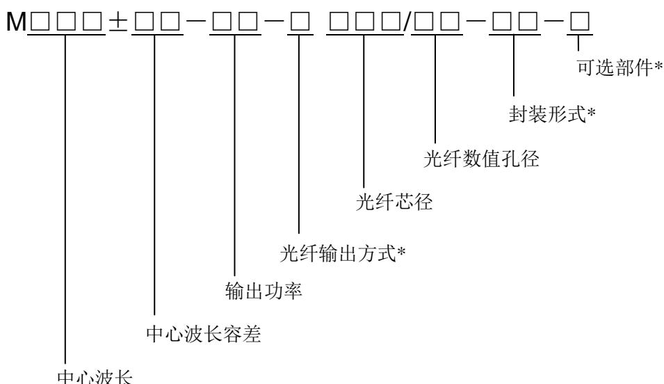
\*可选部件：T - 致冷器、A - 指示光、P - PD、K - 光纤连接头探测器
